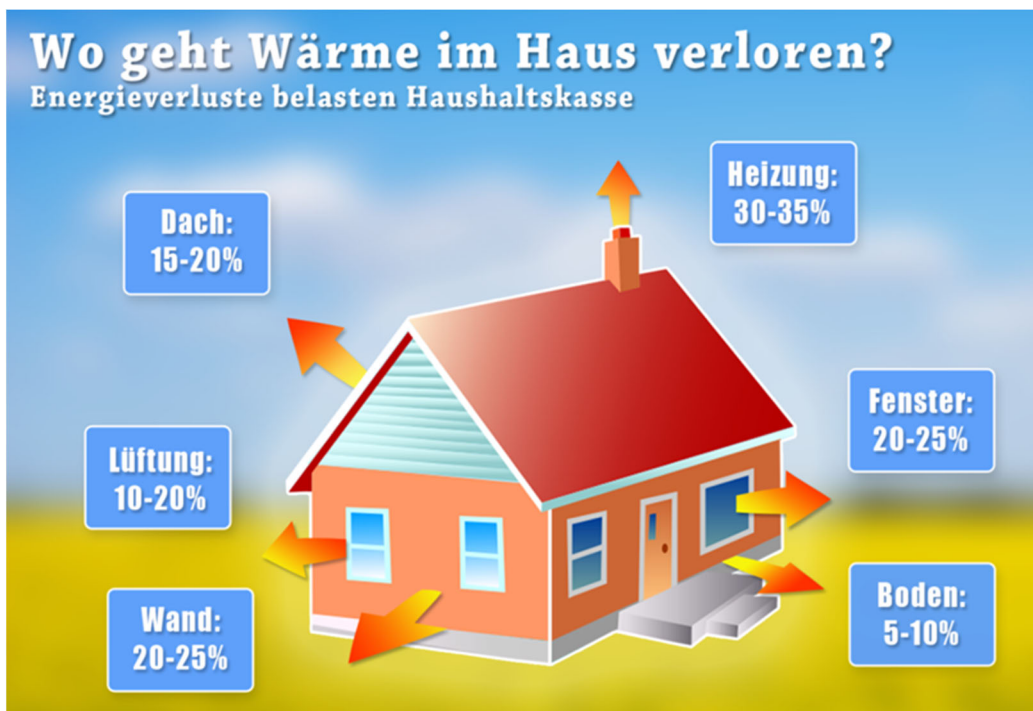
Abbildung 4-2: Energieverluste bei der Wärmeversorgung bestehender Wohngebäude 53
